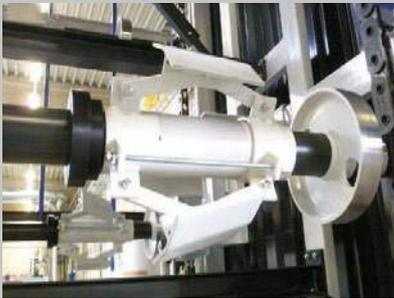
Der Paternoster dient zur Lagerung und Bereitstellung von Coils (z.B. Alu-Bleche, GFK-Materialien) und kann als Pufferspeicher in einer Fließfertigung eingesetzt werden. Kombiniert mit unserem Schneidsystem lässt sich die Anlage hervorragend mit den nachgelagerten Prozessen verketteten. Bei Bedarf können zwei Schneideeinheiten und die doppelte Materialzuführung integriert werden.
